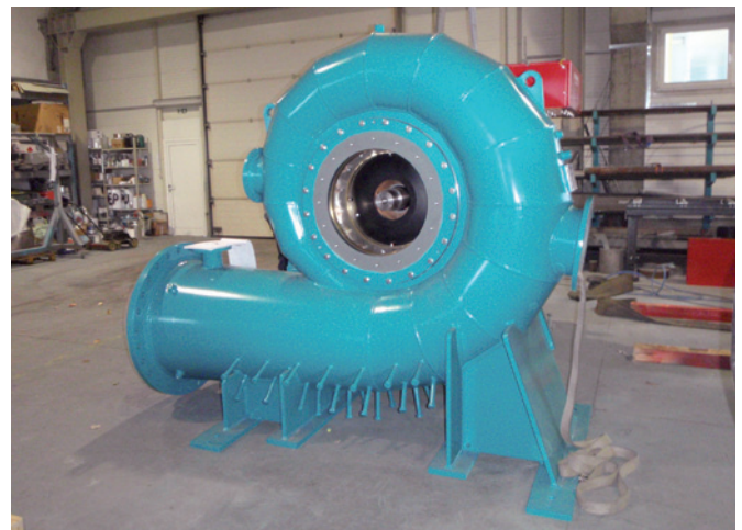
As Samra II, Jordanie – Réception de la turbine Francis en atelier
