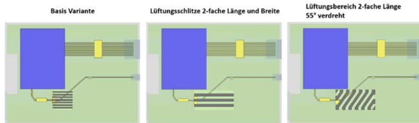
Abbildung 5: Größe und Ausrichtung des Lüftungsbereichs wird variiert, um Lösungsansätze zu finden.
